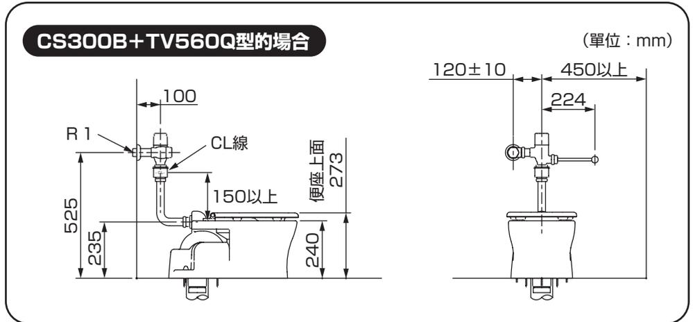
※請確保由真空斷路器側面的「CL線」至馬桶邊緣有150mm以上的距離。
