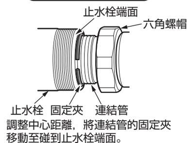
調整中心距離，將連結管的固定夾移動至碰到止水栓端面。
