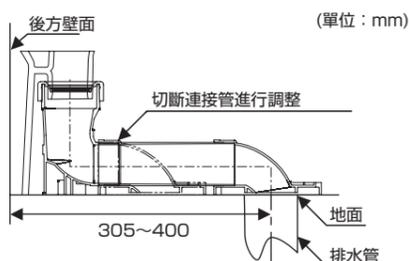
商品組合圖(施工完成圖)AH型
