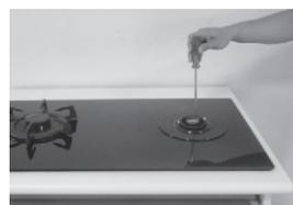
6. 將玻璃天板放置於本體上，調至適當的位置，將天板壓板放置其上，並用零件包內的螺絲鎖固。再依序置入爐頭環蓋、爐頭組、爐架、於正確的定位孔。
