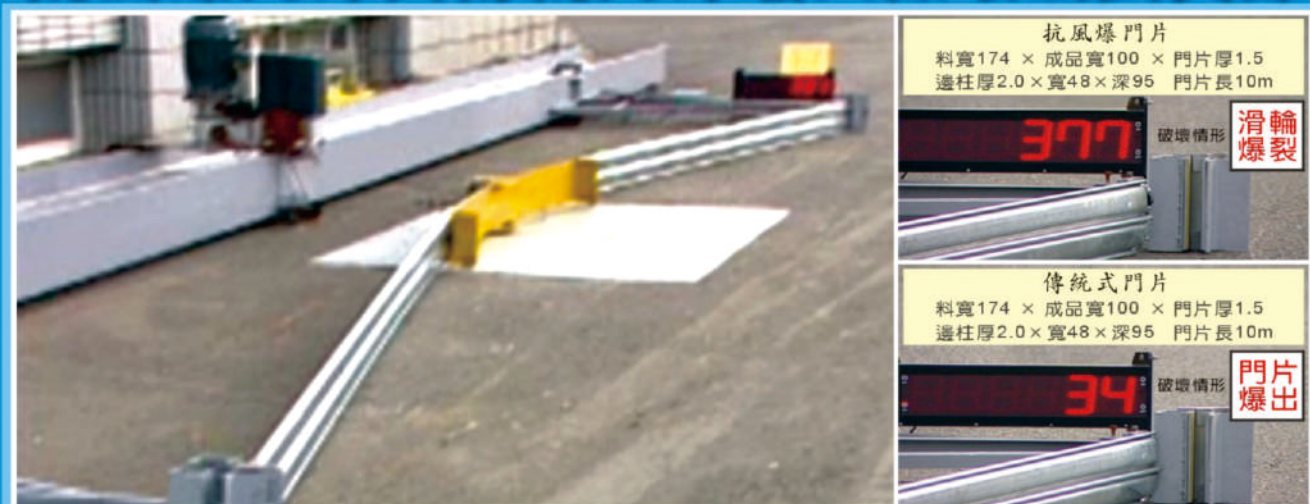
邊柱厚1.5 × 寬42 × 深60 × 門片料寬174 × 成型100 × 厚1.5 × 2支，多種門寬/門片厚最大抗風爆測試對照表 單位/公斤
